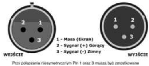
Rys. 1.13 Typy złączy audio
